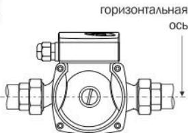
Правильная установка насоса на горизонтальном участке трубопровода
